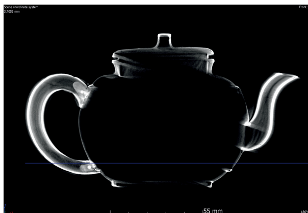
〔图七〕壶A( 故116545 ) 柄使用螺钉固定在壶体突出部分 刘瀚文摄
