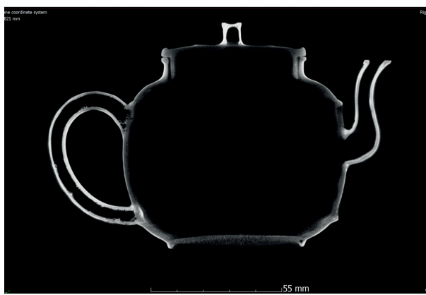
〔图八〕壶D( 故116527 ) 柄直接焊在壶体上 壶B与壶C处理方式与此相同 刘瀚文摄
