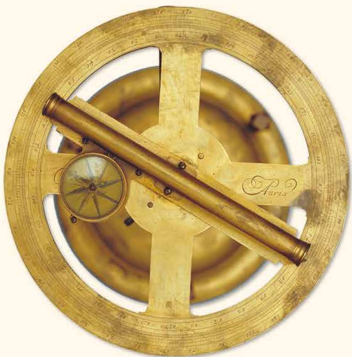
十八世纪 铜镀金双千里镜全圆仪及俯视图部 通高三三厘米 盘直径二二·五厘米 法国制造 故宫博物院藏
