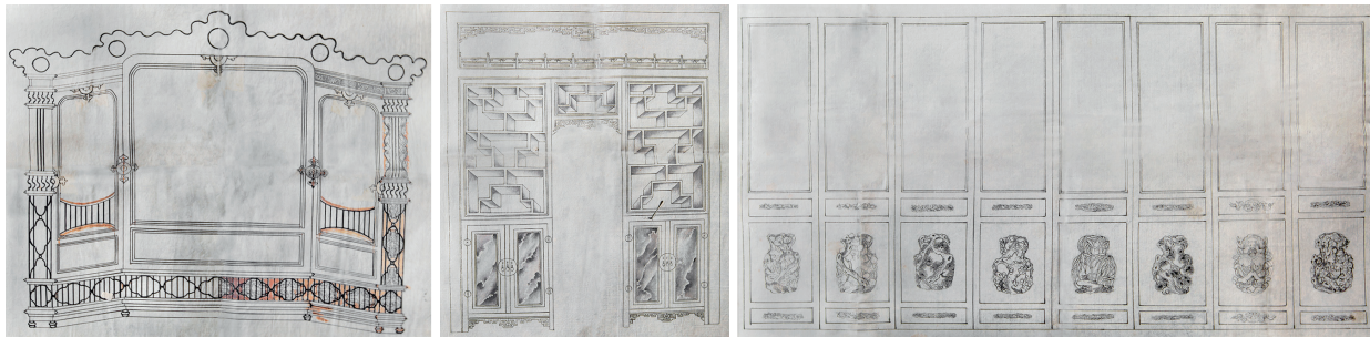
[图十二] 人32五抹榻扇八扇立样(左)、颐和园谐趣园涵远堂西次间后檐西缝西立面图(中)、 图354-1773颐和园谐趣园涵远堂内檐装修落地罩、天然罩立样(局部)(右) 天津大学建筑学院测绘
