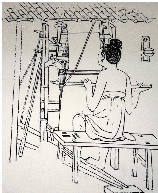
图28 山西开化寺北宋壁画中的竖式织机 (线图来自福建博物院)
