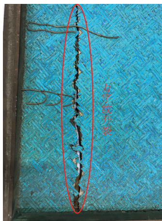
图二一 基底木材变形造成点翠万字纹锦地开裂
