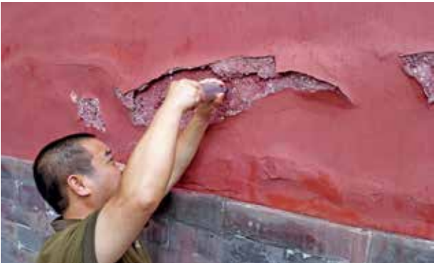
图5 用回弹仪对采样1墙面进行回弹
