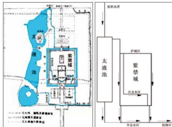
图9 明代皇城河渠平面图(左)及简化图(右)
