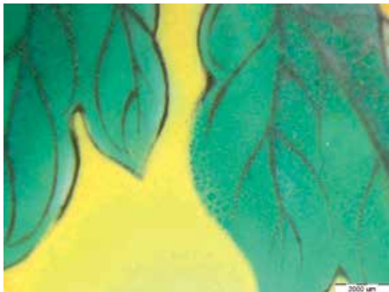
图8 康熙珐琅彩瓷绿色与姜黄色地彩料连接处表面显微照片 (放大40倍)
