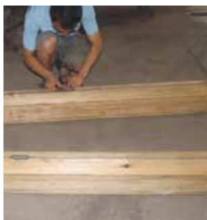
图 7 采用材性相近的木料制作试样
