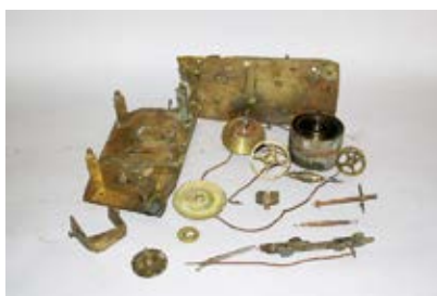
图7 修复前机芯拆解
