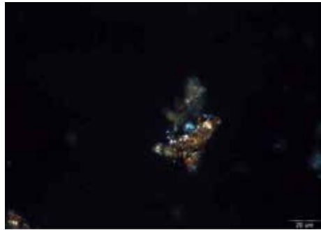
图 27d 3281 样品中铅白颗粒照片 White lead 正交偏光下 Cross-polarized light
