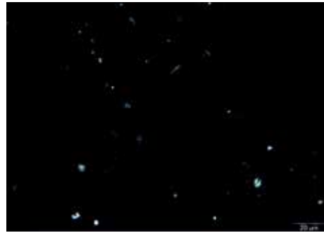
图 24d 3272-1 样品中碳黑颗粒照片 Charcoal Black 正交偏光下 Cross-polarized light
