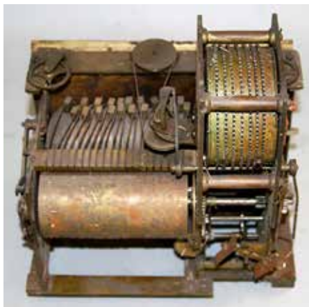
图 10 修前音乐水法机芯背面
