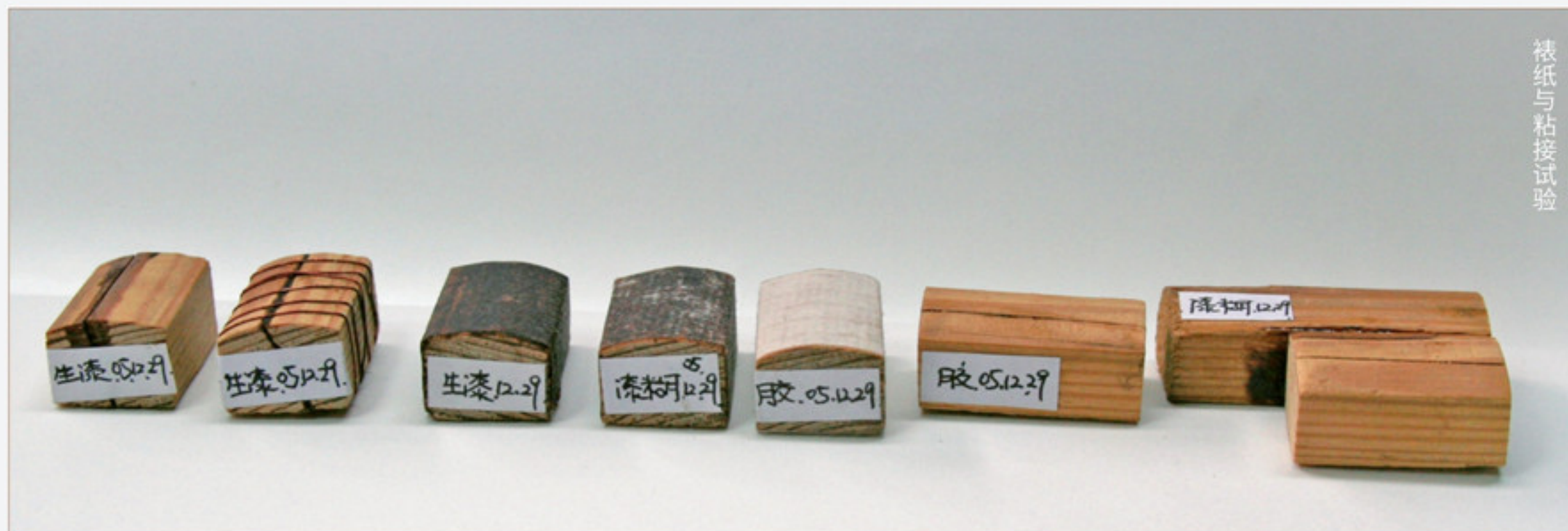
选择同等厚度与强度的纸张，用生漆裱糊在缺失漆灰的木胎上
